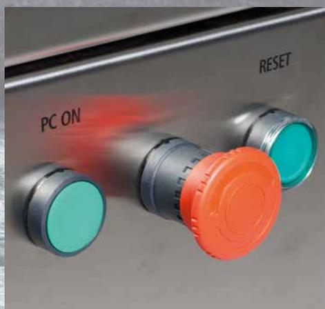
Los pulsadores de encendido del PC, parada de emergencia y reset, están ubicados en la parte frontal de la máquina.
