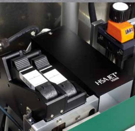
Cámara de visión e inspección: Verificación de códigos y clasificación.
