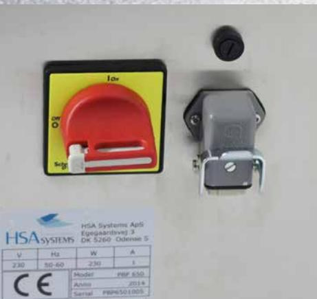
La conexión de alimentación principal, el interruptor ON/OFF principal y fusibles de la alimentación principal se encuentran en la lateral derecho de la máquina.
