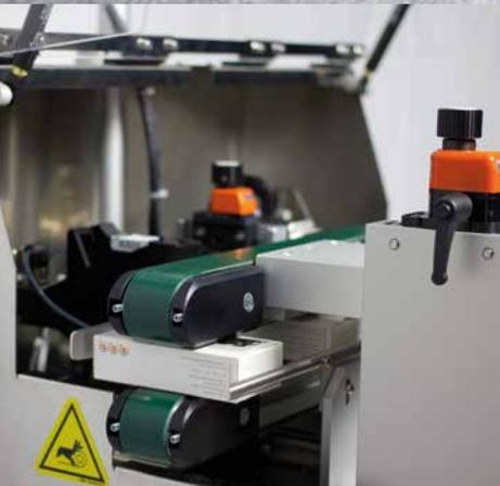
La cinta superior puede regularse en altura entre 10 y 75 mm. Guía sincronizada entre las cintas superior e inferior.
