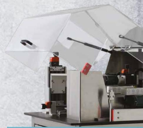
Cubierta superior transparente y micro switch de seguridad.
