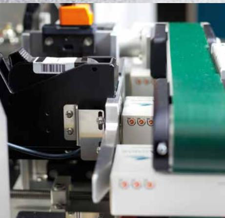
Cabezal de impresión y cámara montados en un soporte común regulable en altura.
