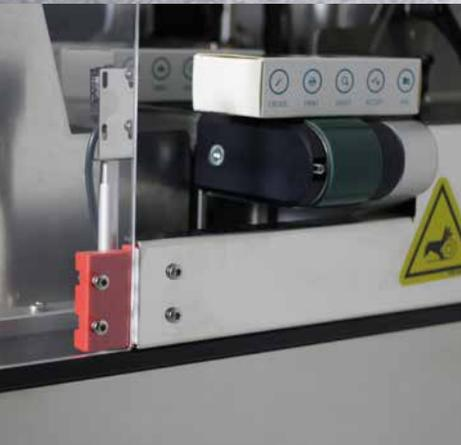
Micro switch de seguridad que detiene la máquina si la cubierta es abierta durante la producción.
